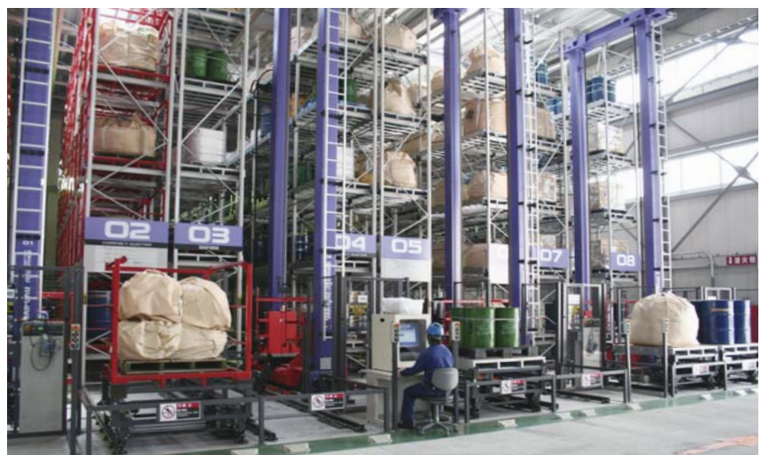
最大積載質量は1.5t/パレット、総格納能力は約600tのCS。パレットからはみ出したり、荷崩れしそうなフレコンバッグは、ポストパレット（左）に積載して格納する。
