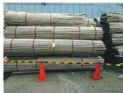
（こうしたチタンパイプも破碎機に投入され原料化に）
